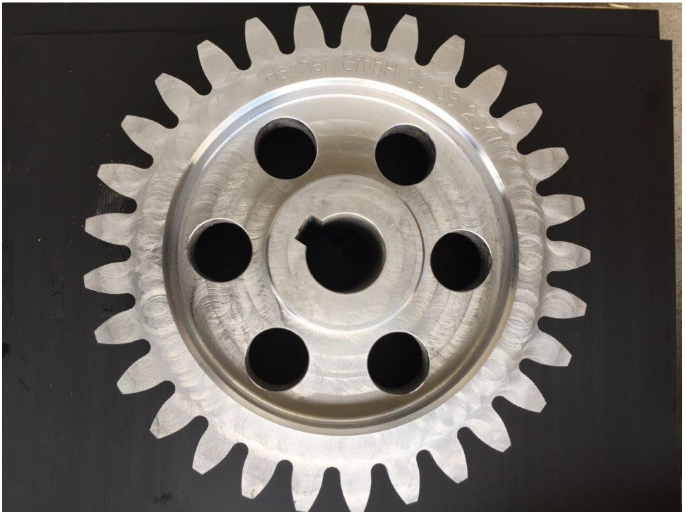
Zahnrad modul 16 / Z 29 Dicke 155mm
